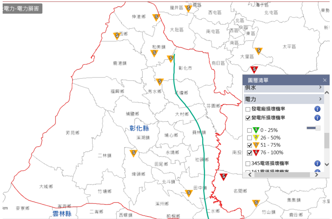
圖 1-3-9 模擬變電所損壞機率
