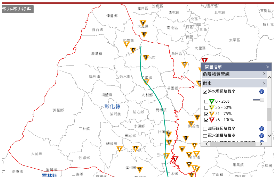
圖 1-3-10 模擬淨水廠損壞機率
